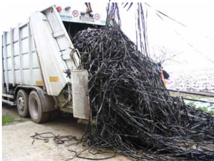
Foto 3 "Camion utilizzato per il recupero dell'ala sfusa o in bobinette"
