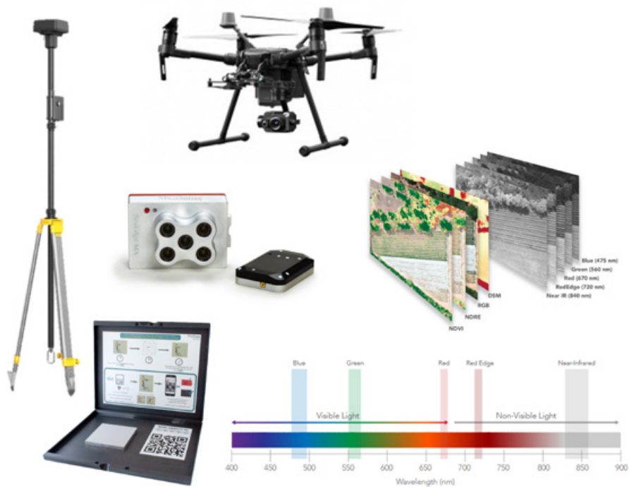
Immagine 4 “Strumentazione utilizzata durante il monitoraggio culturale: drone DJI Matrice 210 RTK e camera multispettrale MicaSense RedEdge-MX”
